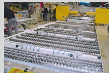
Die Transportstrecke mit integriertem Vakuum-Wendetisch. Die Module werden herangefahren, um 180° gewendet und anschließend ohne Unterbrechung weiter bearbeitet.
