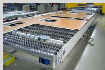
Sauggreifer die nicht belegt sind, werden automatisch abgeschaltet. Alle Sauger können zusätzlich auf weitere Bauteil-Formate eingestellt werden.
