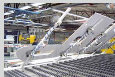
Vakuum-Wendetisch: zum sicheren und rationellen Wenden von vorgefertigten Seitenwänden und Dachmodulen von Reisemobilen/Caravans.
