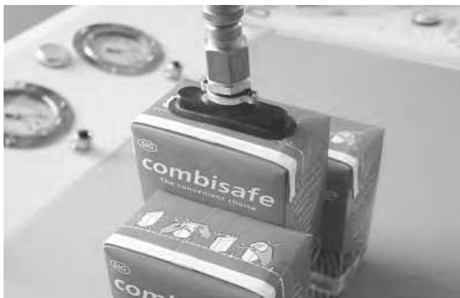
Flachsauggreifer SGON bringen maximale Saugkraft bei reduziertem Platzangebot
