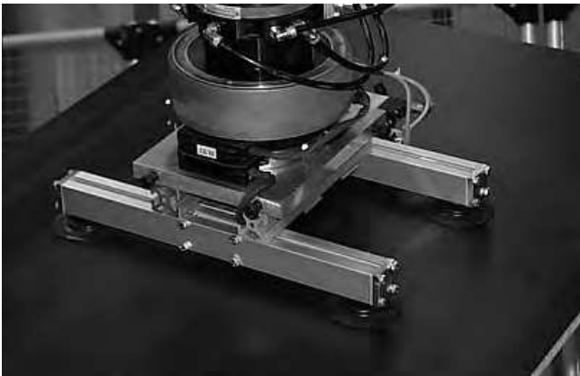
Saugertraverse für das Handling beschichteter Spanplatten, bestückt mit vier Sauggreifern PFYN 80
