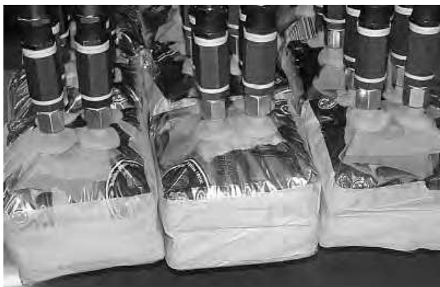
Folien- und Papiersauggreifer SGPN SI bei der Handhabung von Blisterverpackungen
